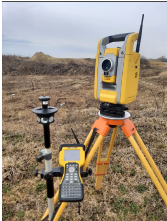
Abb. 13 Links: Totalstation Trimble S3. Rechts: Liste der Fest- und Anschlusspunkte (FP: Grenzsteine, AP-2000 ff.: Wasserschieber o.ä., AP-3000 ff.: temporäre Anschlussnägel).
