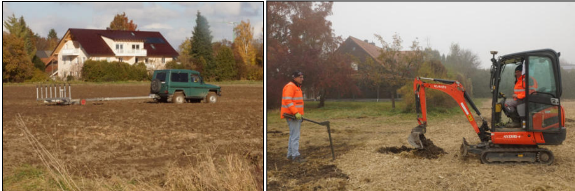
Abb. 1 links: Prospektion der Grundstücke mit Fluxgate-Magnetometer-Sonden. Rechts: Herr Neumann und Herr Münzner beim Freilegen von Verdachtspunkten.
