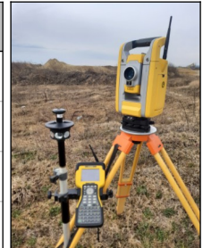
Abb. 10 Links: Liste der Anschlusspunkte. Rechts: Totalstation Trimble S3.
